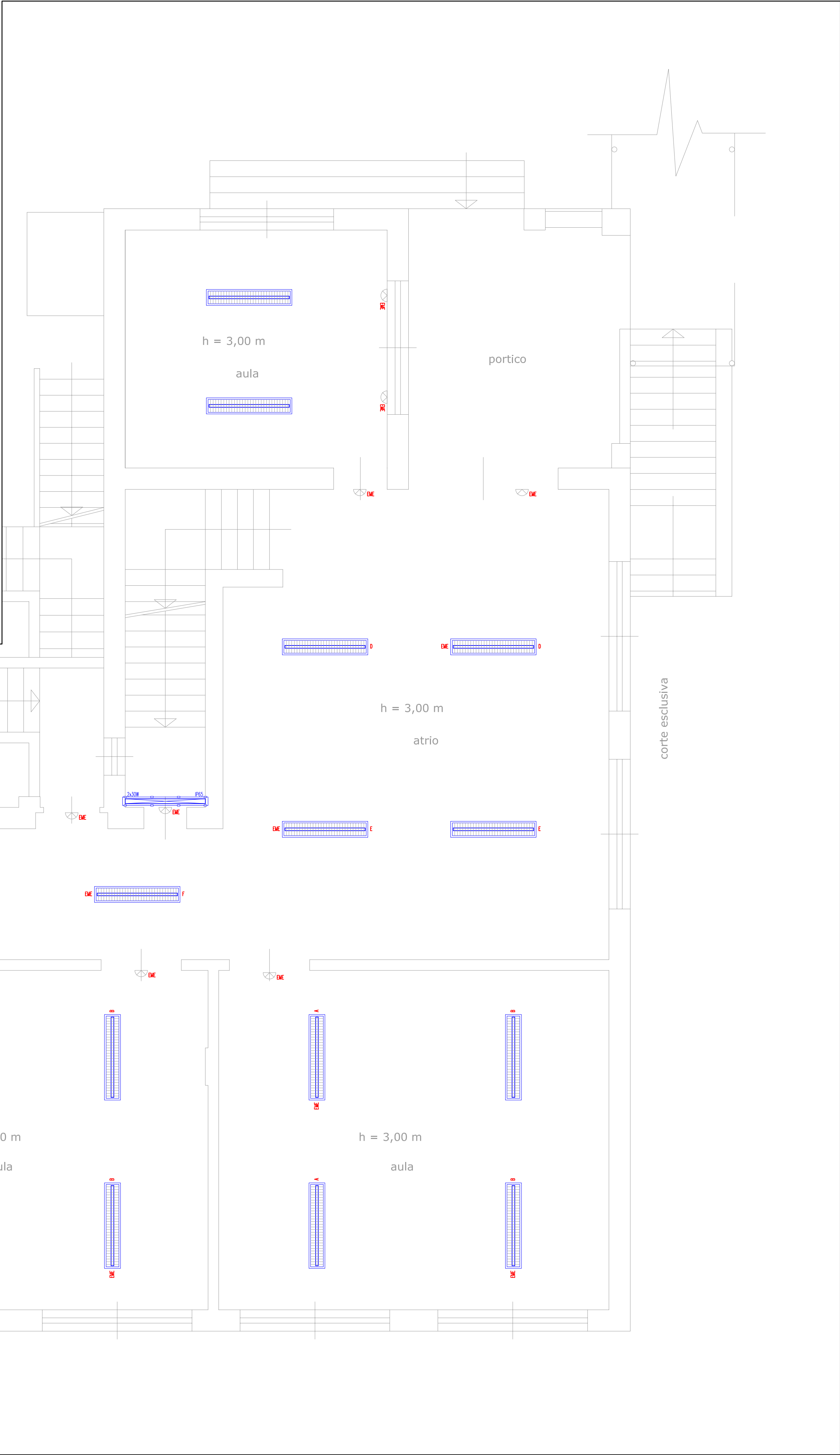
Planimetria impianto di illuminazione - Progetto - Scala 1:50
